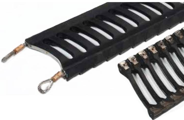
Der CLEANSCRAPE-Vorabstreifer wird direkt unterhalb des Abwurfbereiches installiert. Dieser Abstreifer wird schräg über die Kopftrommel gespannt und bildet eine „Raumkurve“. Die einzelnen Abstreifelemente werden in eine Matrix einvulkanisiert und nur mit geringem Druck an das Förderband angelegt. Trotz eines relativ geringen Kontaktdrucks zwischen Band und Abstreifer wird das anhaftende Material sehr effektiv entfernt.
